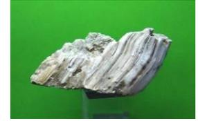
El *yeso blanco*, es un polvo blancuzco, que se mezcla con un volumen igual de agua y que fragua (se endurece) al secarse. Se emplea para elaborar una pasta muy utilizada en el recubrimiento de techos y paredes, y para elaborar molduras y figuras empleando moldes.
