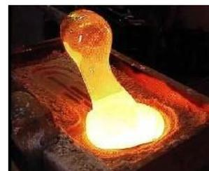
forma correspondiente, en láminas o bien en formas huecas, mediante soplado, y después se deja enfriar. En su fabricación tiene gran importancia la velocidad de enfriamiento del material. Si se enfría rápidamente, resulta muy quebradizo; y un enfriamiento demasiado lento lo vuelve opaco.
